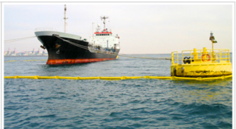
Festkörper Ölsperre Typ 600 S, Shuwei hat Solid Oil Containment Boom, type 600 S, Shuwei hat
