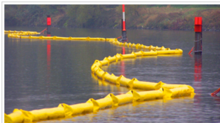
Festkörper Ölsperre, Typ 900 S, Saarbrücken Solid Oil Containment Boom, type 900 S, Saarbrücken
