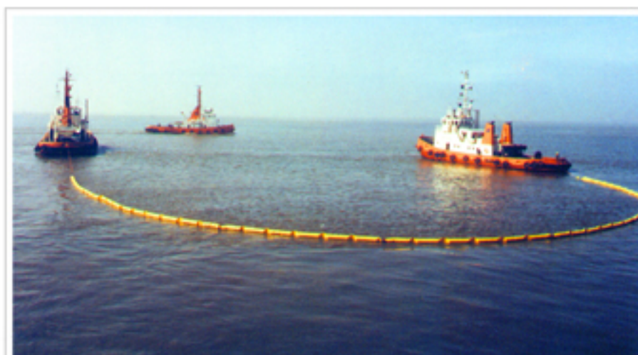
Festkörper Ölsperre, Typ 900, Übung auf der Weser, 200m Solid Oil Containment Boom, type 900, Exercise on the Weser, 200m
